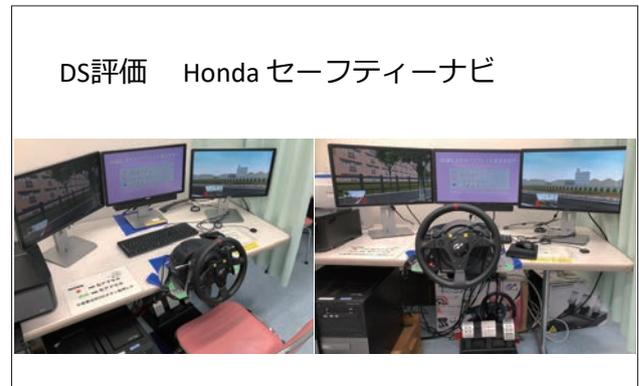
こちらは当院で採用しているシミュレーターになります。簡易型のドライビングシミュレーターでホンダのセーフティナビという運転能力評価サポートソフトを採用しています。パソコンを使用していて、市販のステアリングと組み合わせることで、簡易型のドライビングシミュレーターとして使用しています。方向指示器も設置されていて、アクセルは左右どちらにも設定の変更が可能となっています。大型のドライビングシミュレーターと比較して設置場所を取らず、値段が安いなどの特徴があります。
